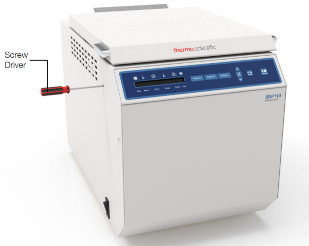
Figure 3. Ouverture d'urgence du couvercle de la chambre
