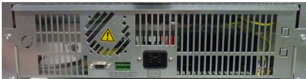
Figura 4-11 Interfacce segnali e collegamento alla rete
