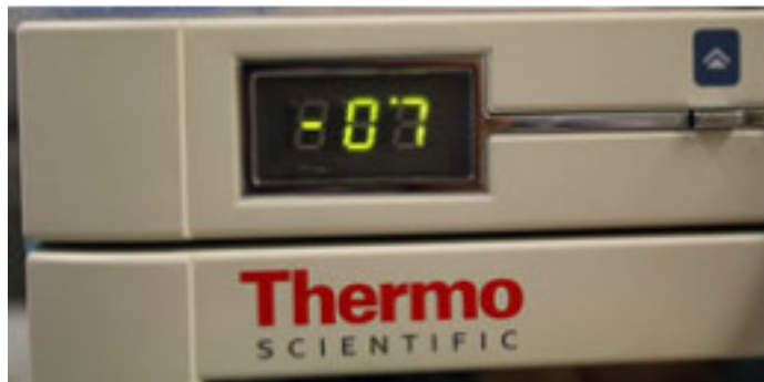
Figura 7-2: Valor de corrección de la regulación indicado en la pantalla de -0,7 °C
