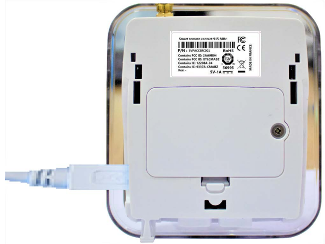
Abbildung 75. Optional: Verbinden Sie den Datenlogger mit der Stromversorgung (USB), um Datenverlust zu verhindern
