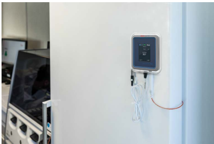
Abbildung 24. An der Kühltür angebrachter Smart-Vue-Pro-Duo-/Quatro-Datenlogger
