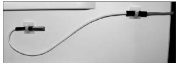
Abbildung 23. Sensor im Inneren der Kühlkammer (ausschließlich Datenlogger mit externem Sensor)
