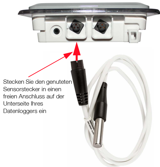
Abbildung 22. Smart-Vue-Pro-Duo-/Quatro-Datenlogger mit externem digitalem Sensor
