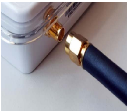
Abbildung 10. Schließen Sie die Antenne an den Stecker an
