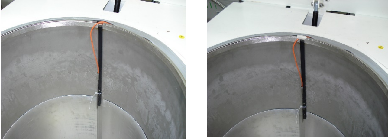
Abbildung 20. Pt100 (-200 °C bis +50 °C) für Stickstoff-/Kryotanks
