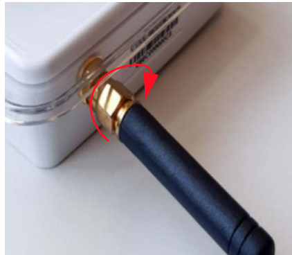
Abbildung 11. Drehen Sie den Ring, um die Antenne am Datenlogger zu befestigen
