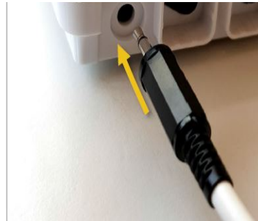
Abbildung 27. Verbinden Sie die Buchse mit dem Eingangsstecker des Trockenkontakts
