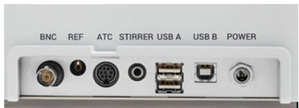
Figura 8. Pannello posteriore del titolatore
