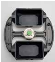
Imagen 2: cruz de rotor con cestillos (la cruz de rotor se vende por separado; a continuación se muestran las opciones)
