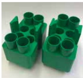
Imagen 4: adaptador de tubo cónico de 50 mL
