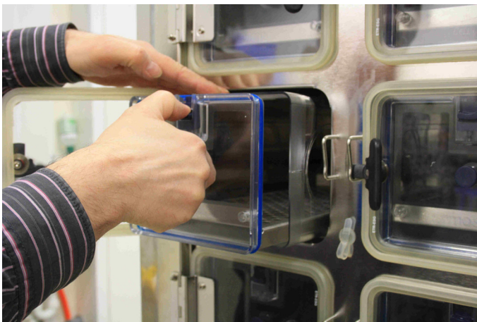
accès aux échantillons à l'intérieur de la chambre avec couvercle de transport
