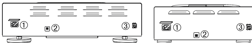
7. ábra: Hátlátnézet (bal: Solaris 4000, jobbra: Solaris 2000)
