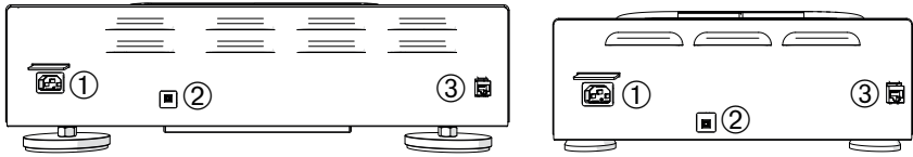
① 电源连接；② 保险丝；③ 以太网端口
