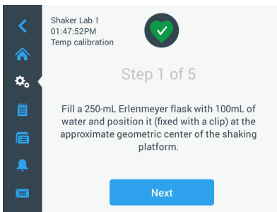
Afbeelding 108: Kalibratie: Commando voor het vullen van een erlenmeyer
