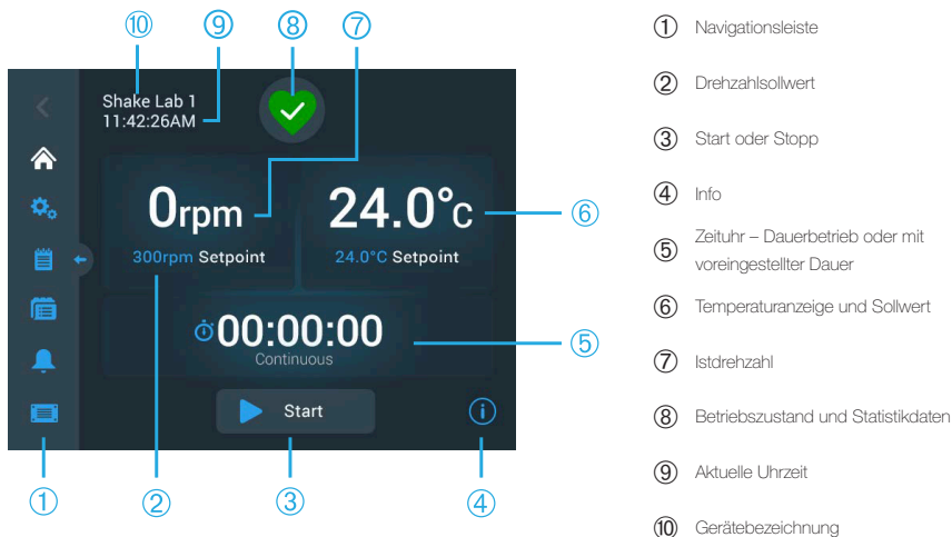
Abbildung 32: GUI Startbildschirm eines temperaturgeregelten Schüttlers
