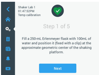
Abbildung 113: Kalibrierung: Aufforderung zum Befüllen eines Erlenmeyerkolbens
