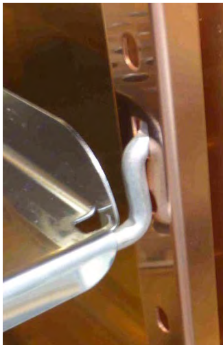
Figure 14-5. Installation d'une étagère métallique perforée
