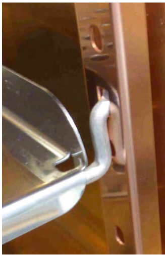
Afbeelding: Plaatsen van het perforatieplaat-inlegstuk
