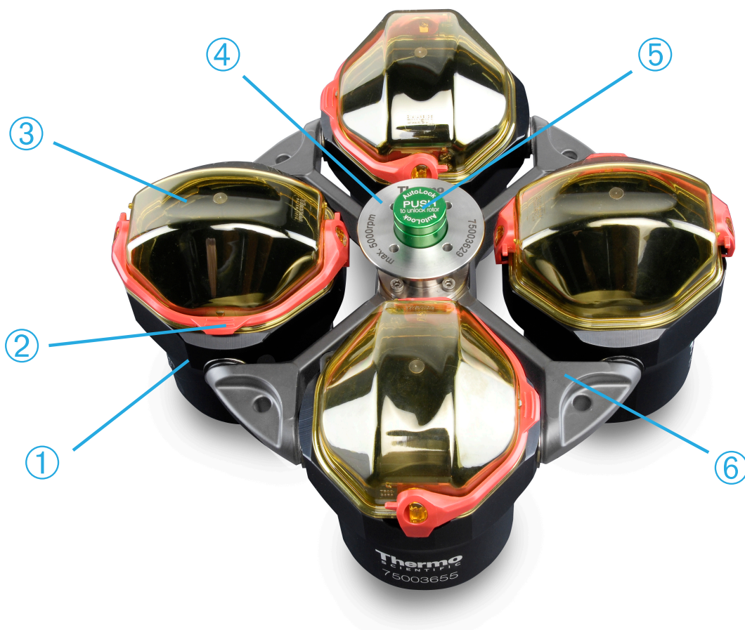
① Cupă; ② Blocare capac; ③ Capac cupă; ④ Buton rotativ rotor; ⑤ Buton Auto-Lock; ⑥ Fiting rotor
