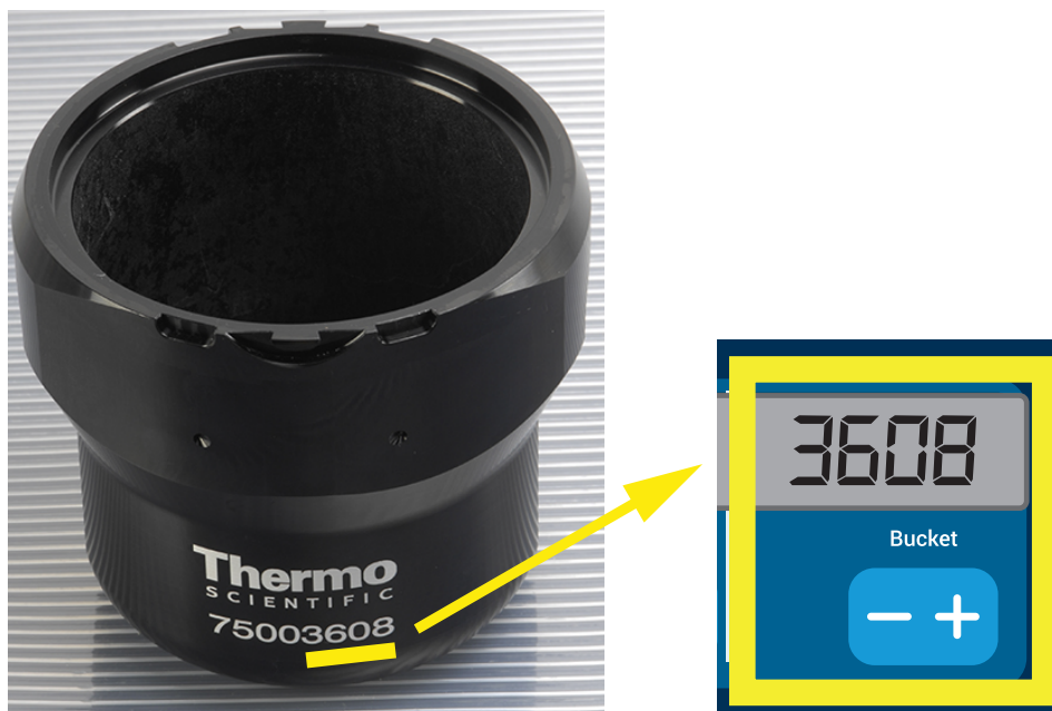
Figură 3-8: Setarea codului corect al cupei pentru rotor
