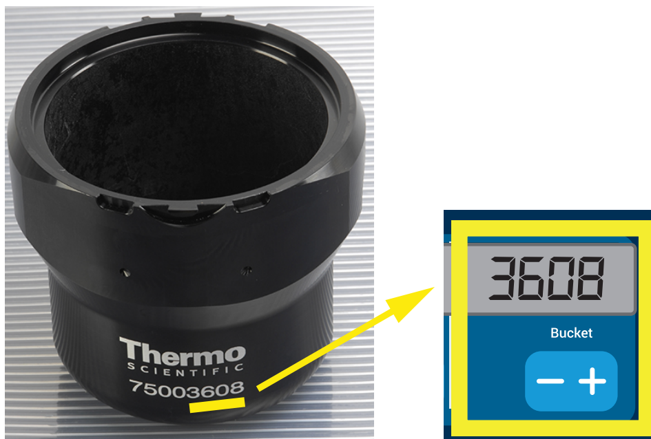
Rysunek 3-8: Ustawianie właściwego kodu kubka dla wirnika
