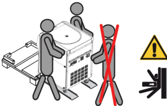
Rysunek 1-8: Zsuwanie wirówki z palety
