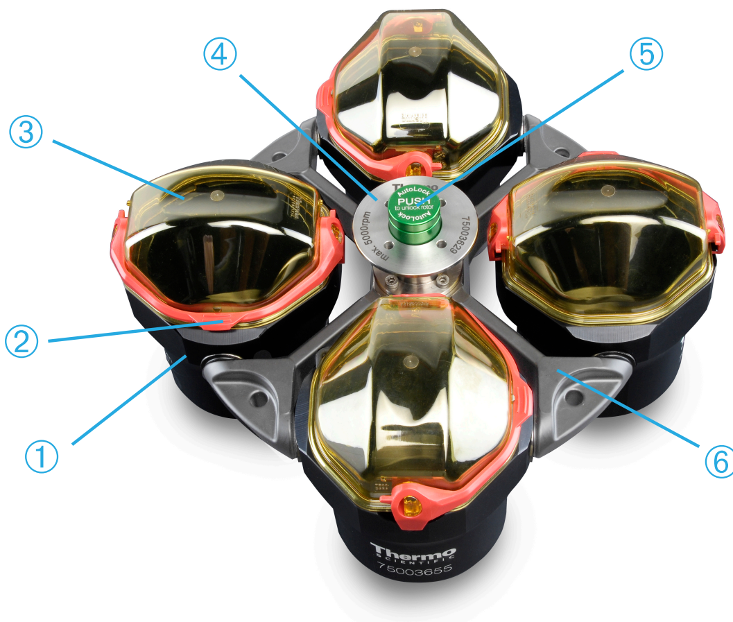
① Kubek; ② Blokada pokrywy kubka; ③ Pokrywa kubka; ④ Gałka wirnika; ⑤ Przycisk Auto-Lock (automatycznego blokowania); ⑥ Głowica wirnika
