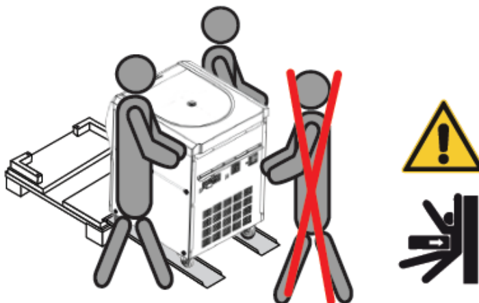
Pav. 1–8: Centrifugos ridenimas nuo padėklo
