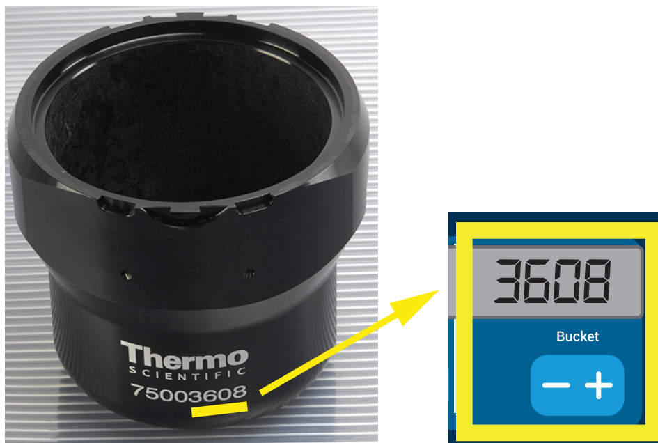
Attēls 3–8: Pareiza rotora kausa koda iestatīšana
