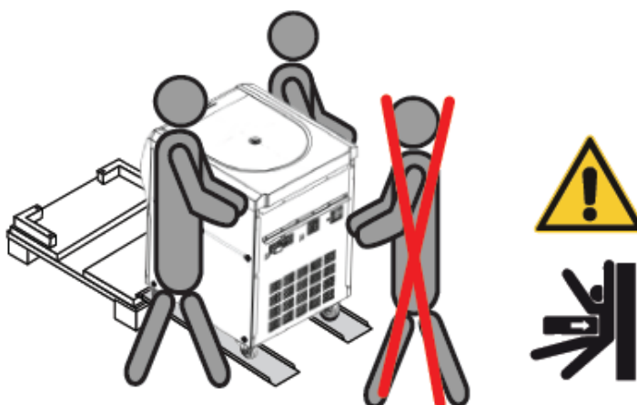
Attēls 1-8: Centrifūgas noripināšana no paletes
