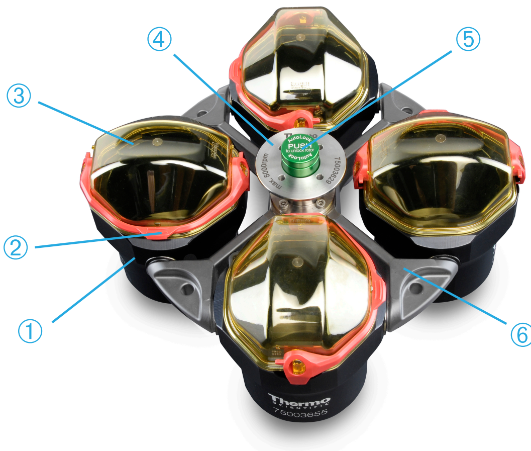
① Kausis; ② Vāka fiksators; ③ Kausa vāks; ④ Rotorā poga; ⑤ Automātiskās bloķēšanas poga; ⑥ Rotorā sakrustojums
