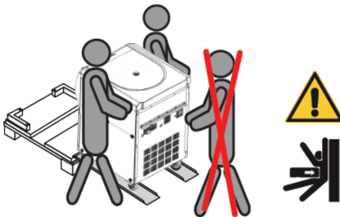
1-8. ábra: A centrifuga legördítése a raklapról
