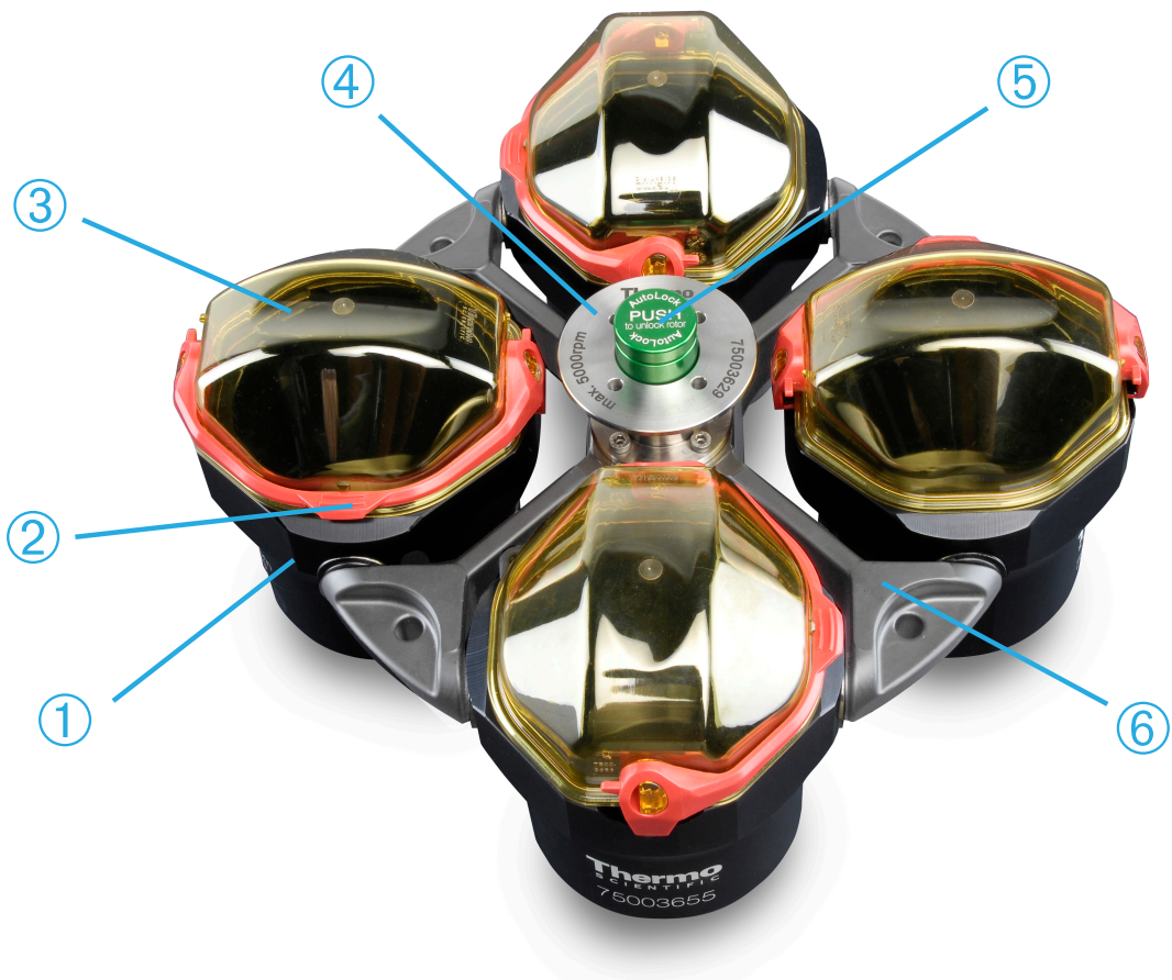
① Kannatinkuppi; ② Kuvun salpa; ③ Kannatinkupin kupu; ④ Roottorin nappi; ⑤ Automaattilukituksen painike; ⑥ Roottorin ristiosa
