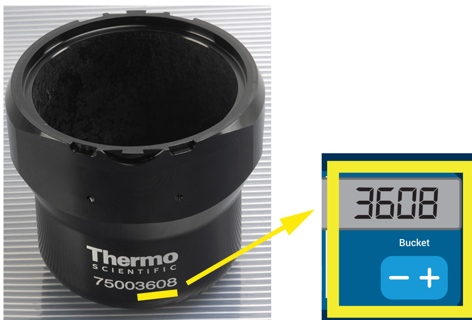
Kuva 3–8: Roottorin kannatinkupin oikean koodin määrittäminen
