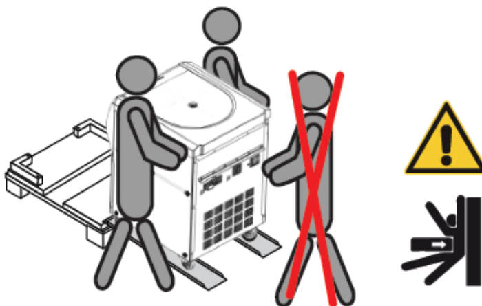
Kuva 1–8: Sentrifugin vierittäminen pois kuormalavalta
