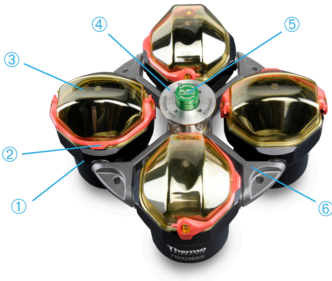
① Bägare, ② Låsanordning ③ Bägjarlock ④ Rotorvred ⑤ Autolås-knapp, ⑥ Rotornav
