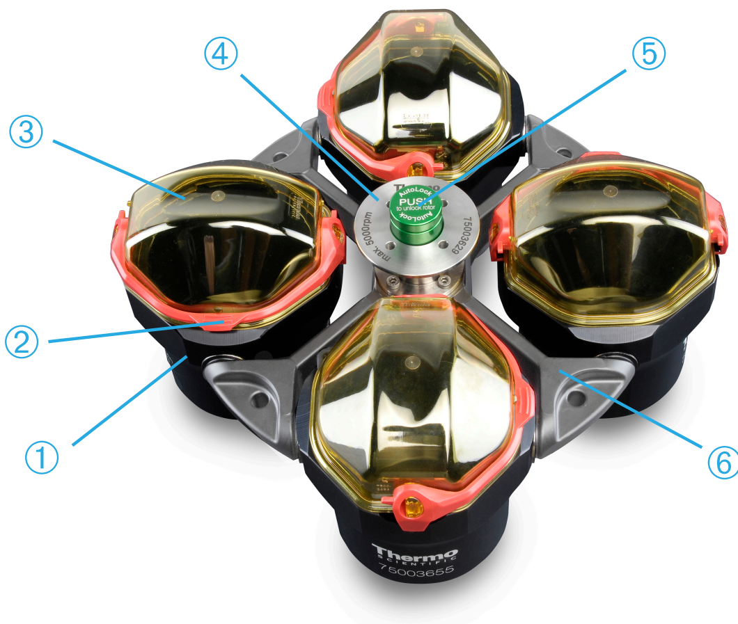
① стакан; ② блокировка крышки; ③ крышка стакана; ④ выступ ротора; ⑤ кнопка Auto-Lock; ⑥ ротор-крестовина
