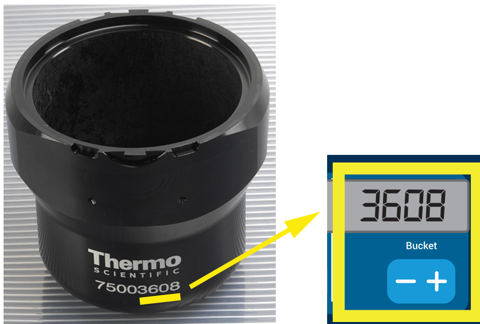
Figur 4–8: Stille inn riktig bøttekode for rotoren
