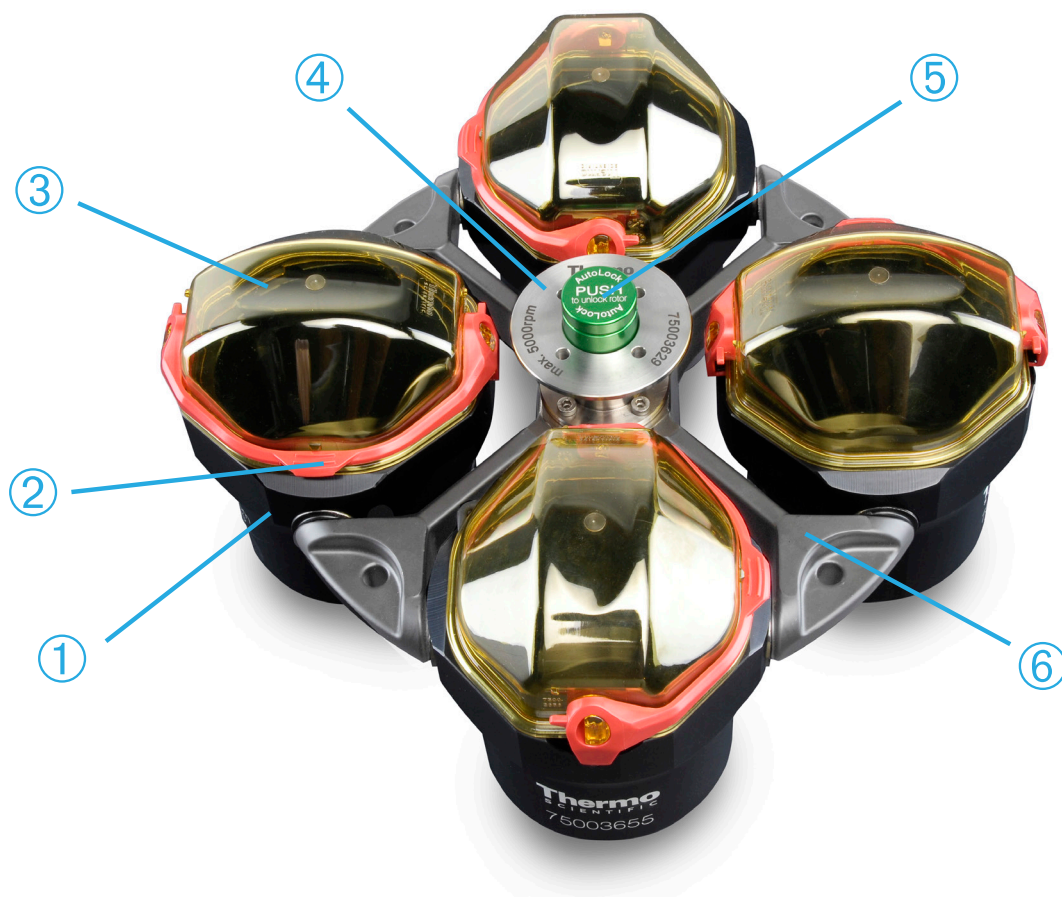
Figur 2-4: Plassering av rotordeler vist på en svingende bøtterotor
