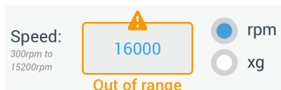
Obraz 3–16: Nastavení -> Ovládací prvky -> stránka Pož. hodnoty: výstražné hlášení Hodnota mimo přípustný rozsah
