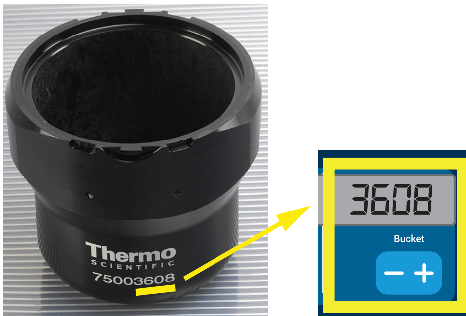
Obráz 4–8: Nastavení správného kódu závěsu pro rotor
