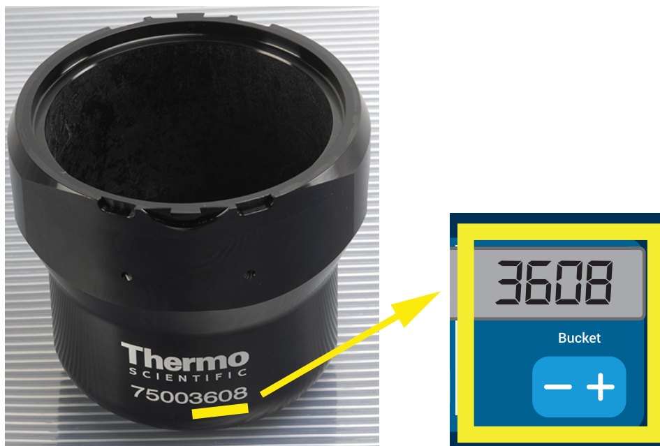
Figur 4–8: Indstilling af den rigtige bægerkode for rotoren
