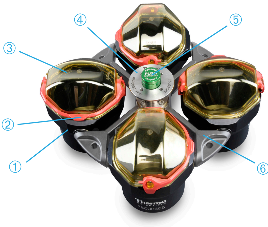
① Bæger; ② Låg-lås; ③ Bægerlåg; ④ Rotorknap; ⑤ Auto-Lock-knap; ⑥ Rotorkryds
