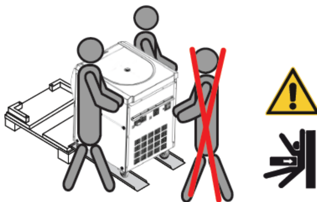
Figura 1-8: Rotolare la centrifuga giù dal pallet
