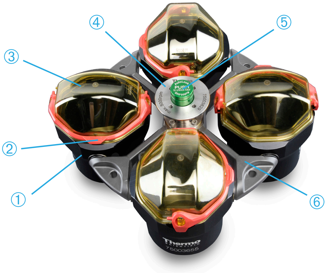
① Cestello; ② Leva di chiusura coperchio; ③ Coperchio del cestello; ④ Pomello del rotore; ⑤ Pulsante di Auto-Lock; ⑥ Croce del rotore
