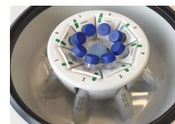
Rotore DualSpin con cestelli ad angolo fisso
