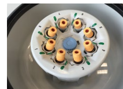
Rotore DualSpin con cestelli oscillanti
