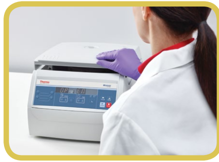
Chiusura rapida a scatto del coperchio della centrifuga
