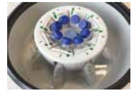
DualSpin-Rotor mit Festwinkelbechern
