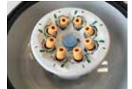
DualSpin-Rotor mit Ausschwingbechern
