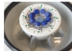
Rotor DualSpin com caçapas de ângulo fixo
