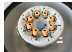
Rotor DualSpin com caçapas oscilantes
