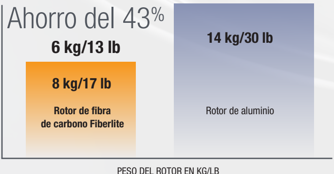
Figura 1: Ahorro de peso con el rotor de fibra de carbono.
